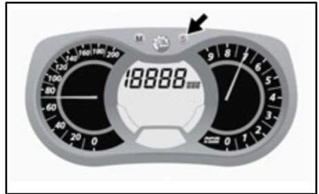
1. Tripp tellermodus (TRIP B) Trykk og hold SET-knappen (S) for å nullstille.
