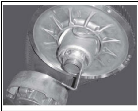
VARIAATTORIN AVAUSTYÖKALU ASENNETTUNA SÄÄTIMEN NAPAAN
