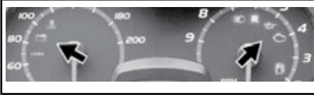
BILDET VISER – KONTROLLAMPER
