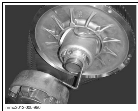
mimo2012-005-980 DISPOSITIVO DI ESPANSIONE DELLA PULEGGIA INSTALLATO SUL MOZZO DEL REGISTRO.
