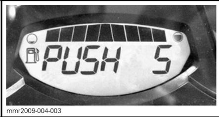
5. Wenn das Anzeigeelement "DRÜCKEN SIE S" anzeigt, lassen Sie alle Tasten los.
