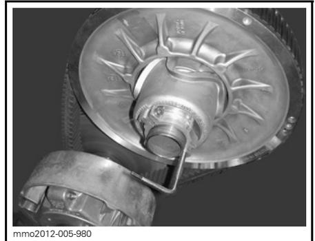
SCHIEBEN-EXPANDER AN NABE DER EINSTELLVORRICHTUNG MONTIERT
