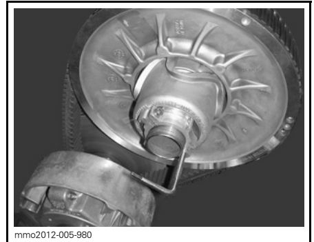
VARIATORNS UTVIDGARE INSTALLERAD PÅ JUSTERINGSNAV I ALUMINIUM
