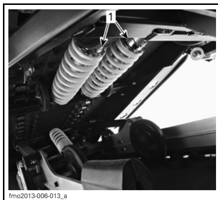
DOBBEL STØTDEMPER BAK 1. Justering av bakre fjæring
