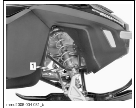
TYPISCH - VORSPANNUNGSEINSTELLUNG DURCH NOCKE 1. Einstellnocken
