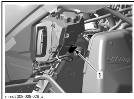
TYPBILD — HÖGER SIDA AV MOTORRUMMET 1. 5 A huvudsäkring
