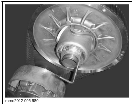
VARIAATTORIN AVAUSTYÖKALU ASENNETTUNA SÄÄTIMEN NAPAAN
