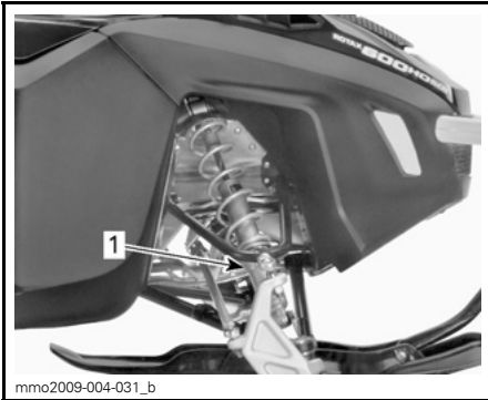
TIPICO - PRECARICO CAMMA 1. Camma di regolazione
