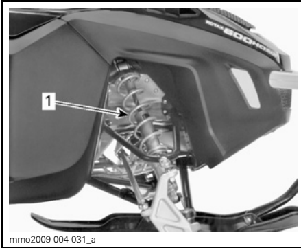
TYPIQUE - SUSPENSION AVANT 1. Ressorts avant pour la maniabilité
