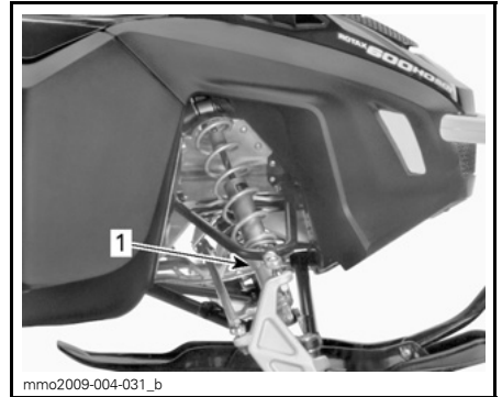
TYPIQUE - PRÉCHARGE DE LA CAME 1. Came de réglage
