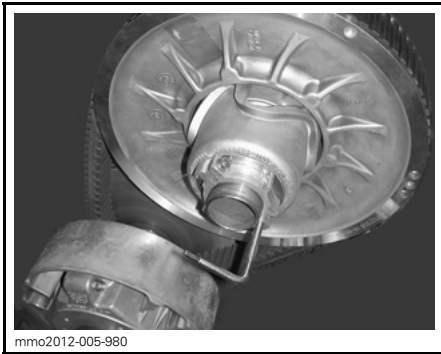
SCHIBEN-EXPANDER AN NABE DER ALUMINIUM-EINSTELLVORRICHTUNG
