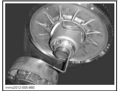
mmo2012-005-980 DISPOSITIVO DI ESPANSIONE DELLA PULEGGIA INSTALLATO SUL MOZZO DEL REGISTRO.
