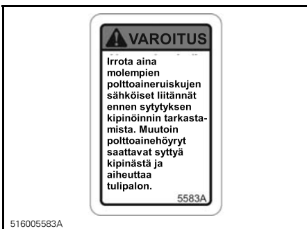
POLTTOAINESUUTTIMITSISSA - 600 E-TEC -MALLIT - KILPI 11
