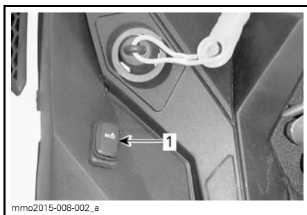
TYYPILLINEN - POLTTOAINESÄILIÖN VASEN PUOLI 1. Tilakatkaisin
