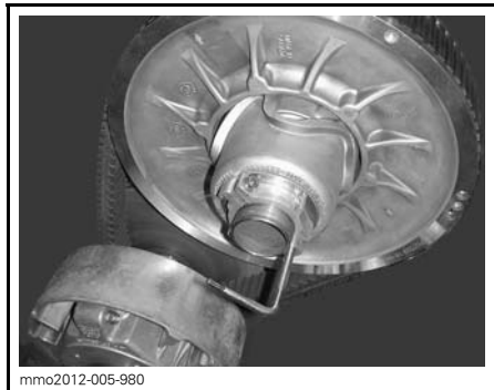
VARIAATTORIN AVAUSTYÖKALU ALUMIINISEN SÄÄTIMEN NAVASSA
