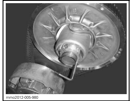
VARIAATTORIN AVAUSTYÖKALU ALUMIINISEN SÄÄTIMEN NAVASSA
