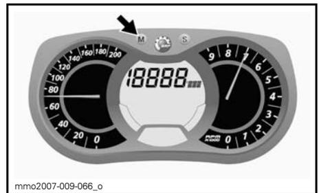
Pour réinitialiser, appuyez sur le bouton MODE (M) pour sélectionner le mode.
