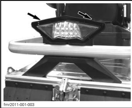
**AVIS** Les broches de retenue en plastique pourraient se casser si le bloc optique de feu arrière est tiré latéralement. Évitez tout mouvement latéral lorsque vous extrayez le bloc optique de feu arrière.
