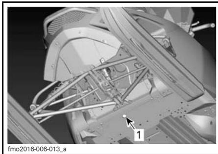
1. Ouverture du châssis pour atteindre le bouchon de vidange
