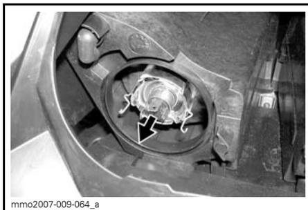
RETIREZ L'AMPOULE ET REMPLACEZ-LA
