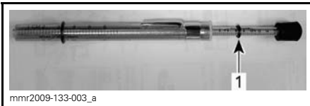
LASTMESSWERT 1. Oberer O-Ring
