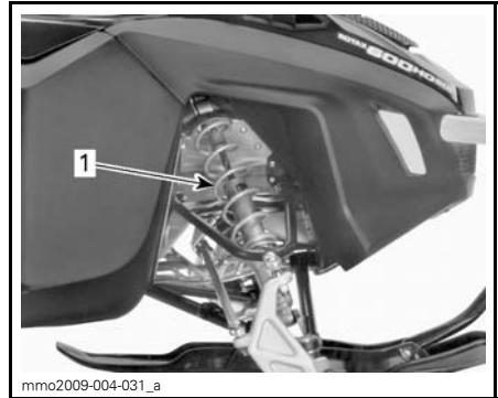
TYPISCH - VORDERE AUFHÄNGUNG 1. Vordere Federn für Fahrverhalten
