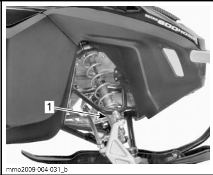
TYPISCH - VORSPANNUNGSEINSTELLUNG DURCH NOCKE 1. Einstellnocken
