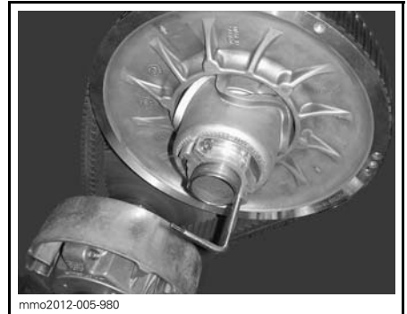
VARIATORNS UTVIDGARE INSTALLERAD PÅ JUSTERINGSNAVET
