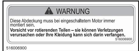
**AUFKLEBER 3- AUF SCHEIBENABDECKUNG UND AUF BREMSSCHEIBENSCHUTZVORRICHTUNG**
