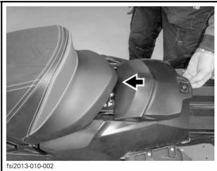
Einbau durch Verriegeln der Aufbewahrungs-/Batteriefachabdeckung abschließen.
