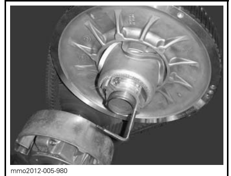
VARIAATTORIN AVAUSTYÖKALU ASENNETTUNA SÄÄTIMEN NAPAAN
