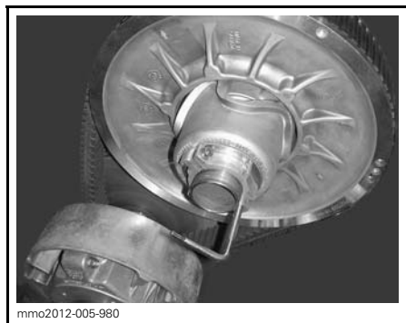
DISPOSITIVO DI ESPANSIONE DELLA PULEGGIA SUL MOZZO DEL REGISTRO IN ALLUMINIO.
