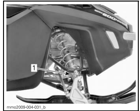
TIPICO - PRECARICO CAMMA 1. Camma di regolazione
