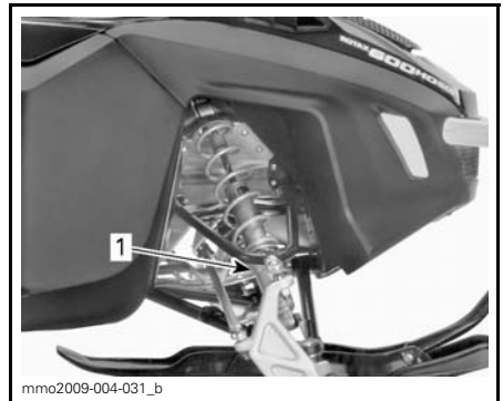
ESIMERKKI - SÄÄTÖNOKKATYYPPINEN ESIJÄNNITYS 1. Säätönokka
