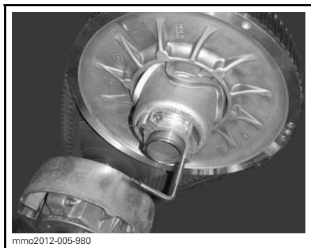
VARIAATTORIN AVAUSTYÖKALU ALUMIINISEN SÄÄTIMEN NAVASSA
