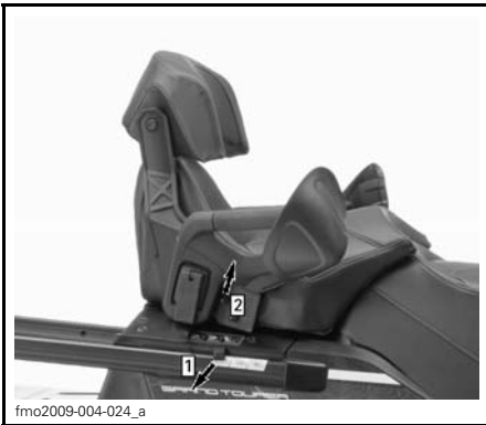
Fase 1: Tirare la linguetta di gomma Fase 2: Sollevare il lato Dx
