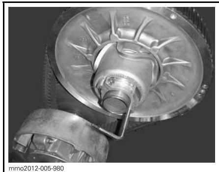
mmo2012-005-980 VARIAATTORIN AVAUSTYÖKALU ALUMIINISEN SÄÄTIMEN NAVASSA
