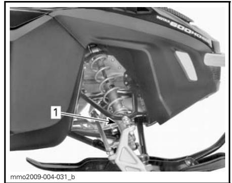
TYPISCH - VORSPANNUNGSEINSTELLUNG DURCH NOCKE
