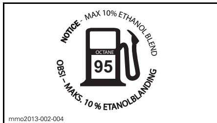
PLASSERT PÅ DRIVSTOFFTANKLOKKET
