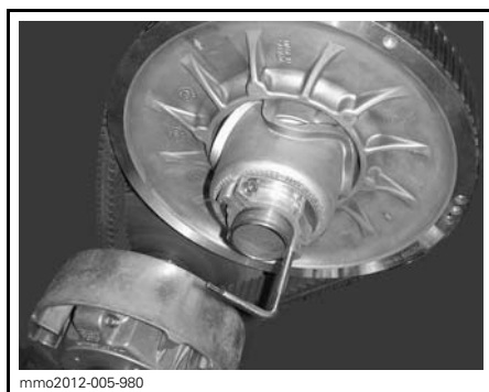
VARIAATTORIN AVAUSTYÖKALU ASENETTUNA SÄÄTIMEN NAPAAN
