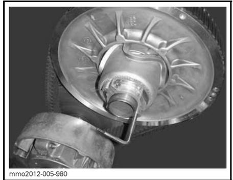
**PULLEY EXPANDER INSTALLED ON ADJUSTER HUB**
