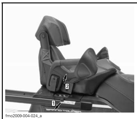
Fase 1: Tirare la linguetta di gomma Fase 2: Sollevare lato DX
