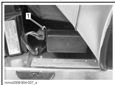
1. Boîte à fusibles
