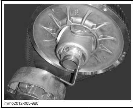
MANDRIN DE POULIE MENÉE SUR UN DISPOSITIF DE RÉGLAGE EN ALUMINIUM
