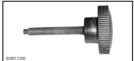
STRUMENTO DI APERTURA DELLA PULEGGIA CONDOTTA
