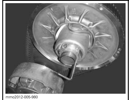
SCHIEBEN-EXPANDER AN NABE DER EINSTELLVORRICHTUNG MONTIERT
