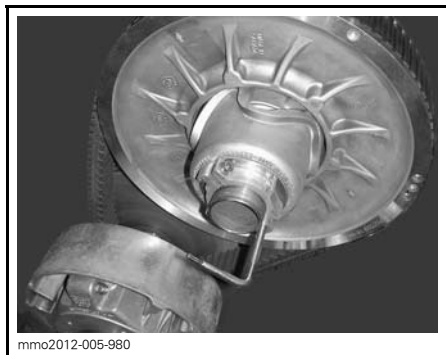
VARIATORNS UTVIDGARE INSTALLERAD PÅ JUSTERINGSNAVET
