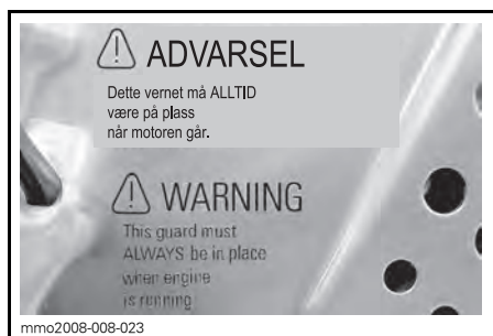
DEKAL 5 – (PÅ VENSTRE SIDE) PÅ BREMSEKIVEVERN (BART METALL PÅ TUNNEL)
