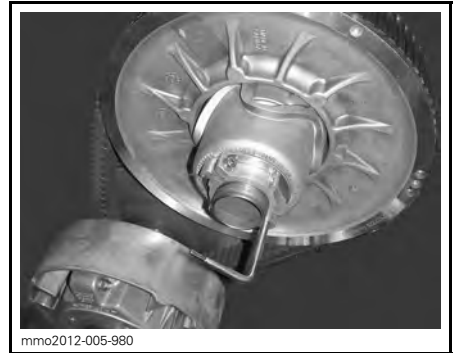
FORLENGER FOR DRIVREIMSKIVE MONTERT PÅ JUSTERINGSNAV
