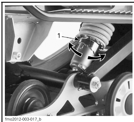
fmo2012-003-017_b AMORTISSEUR DE MANIABILITÉ - À CLIQUET DE RÉGLAGE
