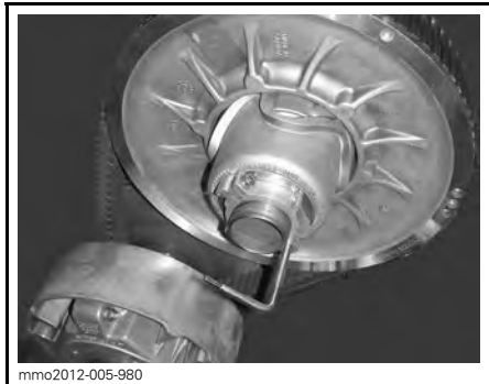
VARIATORNS UTVIDGARE INSTALLERAD PÅ JUSTERINGSNAVET
