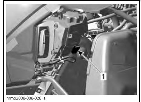
TYPISCH — RECHTE SEITE DES MOTORRAUMS 1. 5-A-Hauptsicherung
