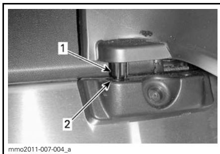
1. Paneltapp 2. Hål i tunneln
