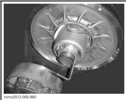
FORLENGER FOR DRIVREIMSKIVE MONTERT PÅ JUSTERINGSNAV
