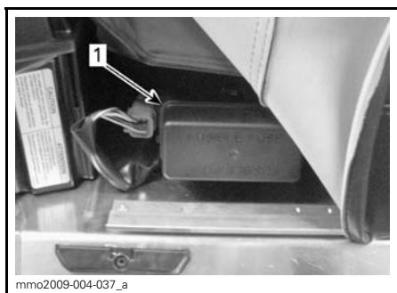
1. Boîte à fusibles
