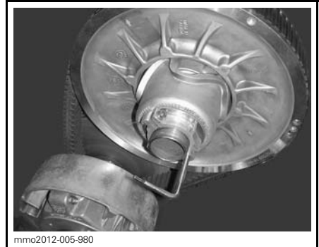
SCHLEIBEN-EXPANDER AN NABE DER EINSTELLVORRICHTUNG MONTIERT
