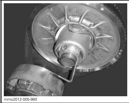
VARIATORNS UTVIDGARE INSTALLERAD PÅ JUSTERINGSNAV I ALUMINIUM
