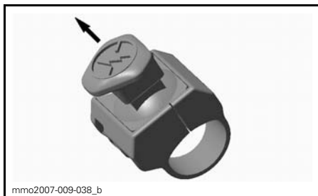
ON (PÄÄLLÄ) -ASENTO
