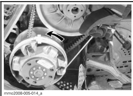
6. Ziehen Sie das Seil mit einem schnellen, kräftigen Zug, so dass das Seil von der Antriebsriemenscheibe los kommt.
