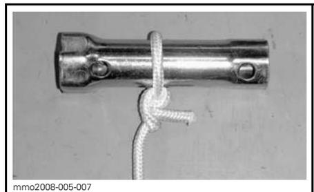
3. Befestigen Sie das andere Ende der Notfall-Startleine an der Starterklemme aus dem Werkzeugsatz.
