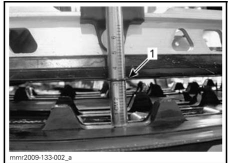
1. Durchbiegungs-O-Ring mit Gleitschuh ausgerichtet
