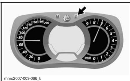
**STUNDEN** einstellen: Stellen Sie mithilfe der Taste SET (S) die Stunden ein, während der Wert **STUNDEN** blinkt.
