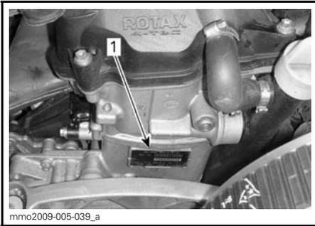
**1200 4-TEC-MOTOR****1. Motorseriennummer**
