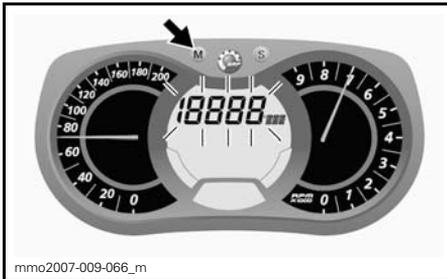
Alors que l'affichage clignote, appuyer sur le bouton de réglage (S) pour sélectionner le mode indicateur de vitesse.
