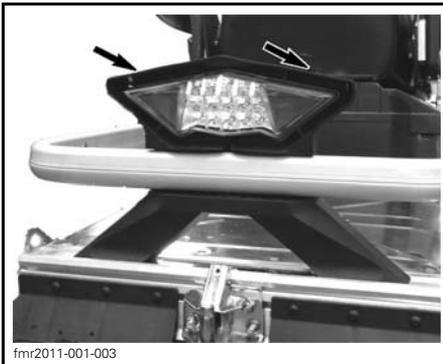
**AVIS** Les goupilles de retenue en plastique peuvent se briser si on force le feu arrière latéralement. Éviter de faire un mouvement latéral lorsqu'on retire le feu arrière.
