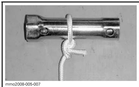
3. Attacher l'autre extrémité du câble d'urgence à l'agrafe de démarrage fournie dans le nécessaire d'outils.
