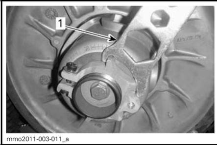
**DISPOSITIF DE RÉGLAGE EN ALUMINIUM**
