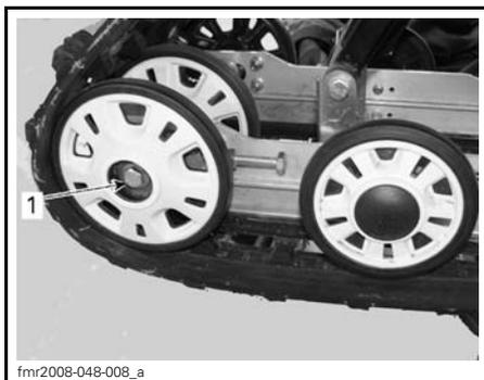
1. Vis de fixation de roue de support arrière droite
