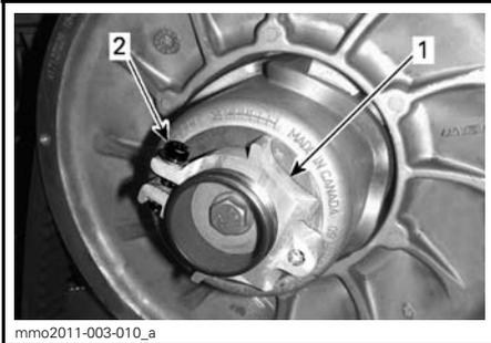
**DISPOSITIF DE RÉGLAGE EN ALUMINIUM**
