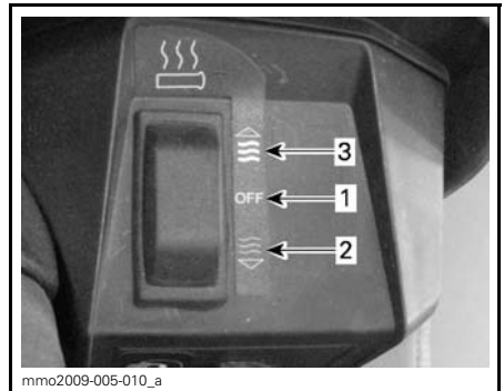
1. Pois päältä 2. Lämmin 3. Kuuma
