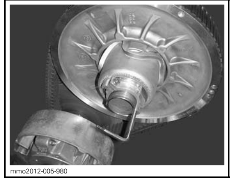
VARIAATTORIN AVAUSTYÖKALU ALUMIINISEN SÄÄTIMEN NAVASSA
