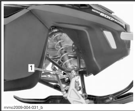
mme2009-004-031_b TYPISCH - VORSPANNUNGSEINSTELLUNG DURCH NOCKE 1. Einstellnocken
