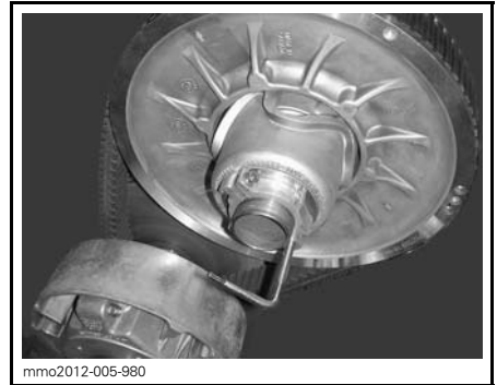
FORLENGER FOR DRIVREIM MONTERT PÅ JUSTERINGSNAV
